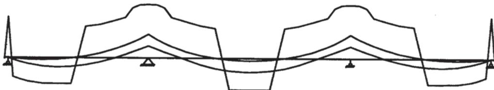
图 3 主梁截面抵抗正、负弯矩的截面抗力及最不利荷载弯矩图 (单位  $\text{kg}/\text{cm}^2$ )
