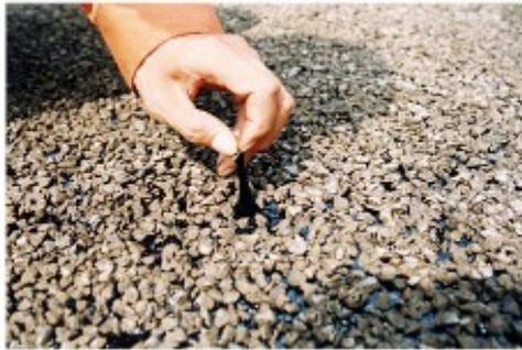
图 1 橡胶沥青具有优良的粘弹性能
