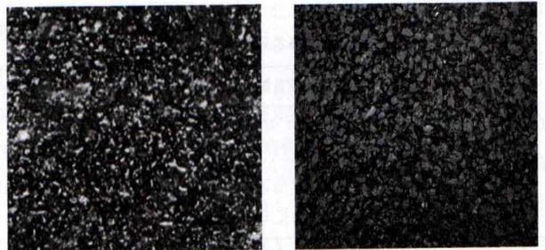
图2 恩施石灰石(左)和京山玄武岩(右)制备SMA-16施工后的表面现状构造
